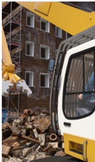
Abb. 94 Kabine mit Schutzgitter
