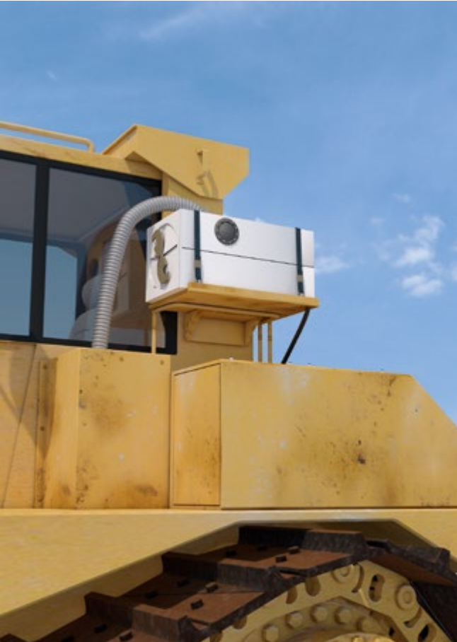
Abb. 15 Filteranlage zur Atemluftversorgung des Geräteführers
