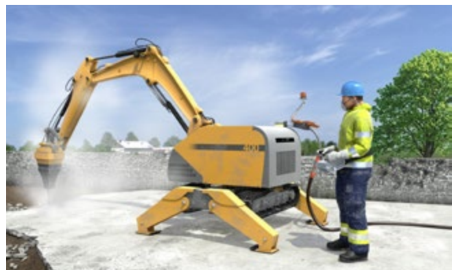
Abb. 102 ferngesteuerte Abbruchmaschine statt handgeführte Werkzeuge
