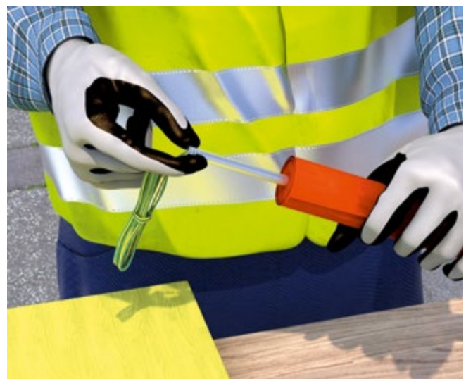
Abb. 120 Herstellen einer Initialladung
