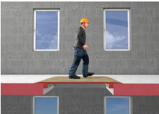
Abb. 3 Sicherung von Deckenöffnungen (Schnittdarstellung)
