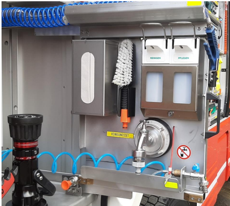
Hygieneboard an einem Fahrzeug mit Wasserversorgung
